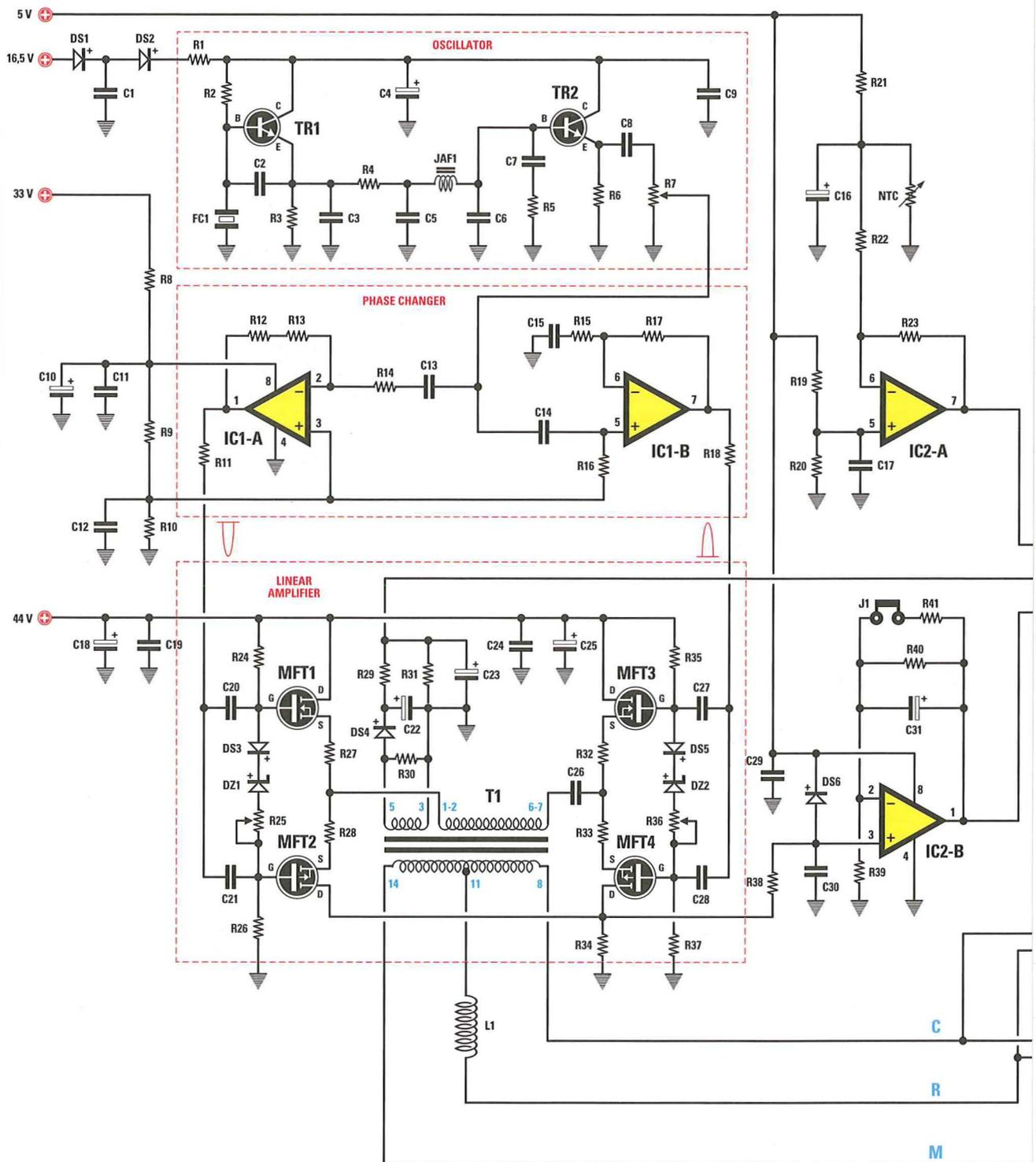
Fig.14 Schema elettrico dell'apparecchio per DCR. Sono visibili, partendo dall'alto il circuito oscillatore, il circuito sfasatore, e l'amplificatore lineare a Mosfet. A destra, il microcontrollore che presiede al funzionamento dello strumento.
