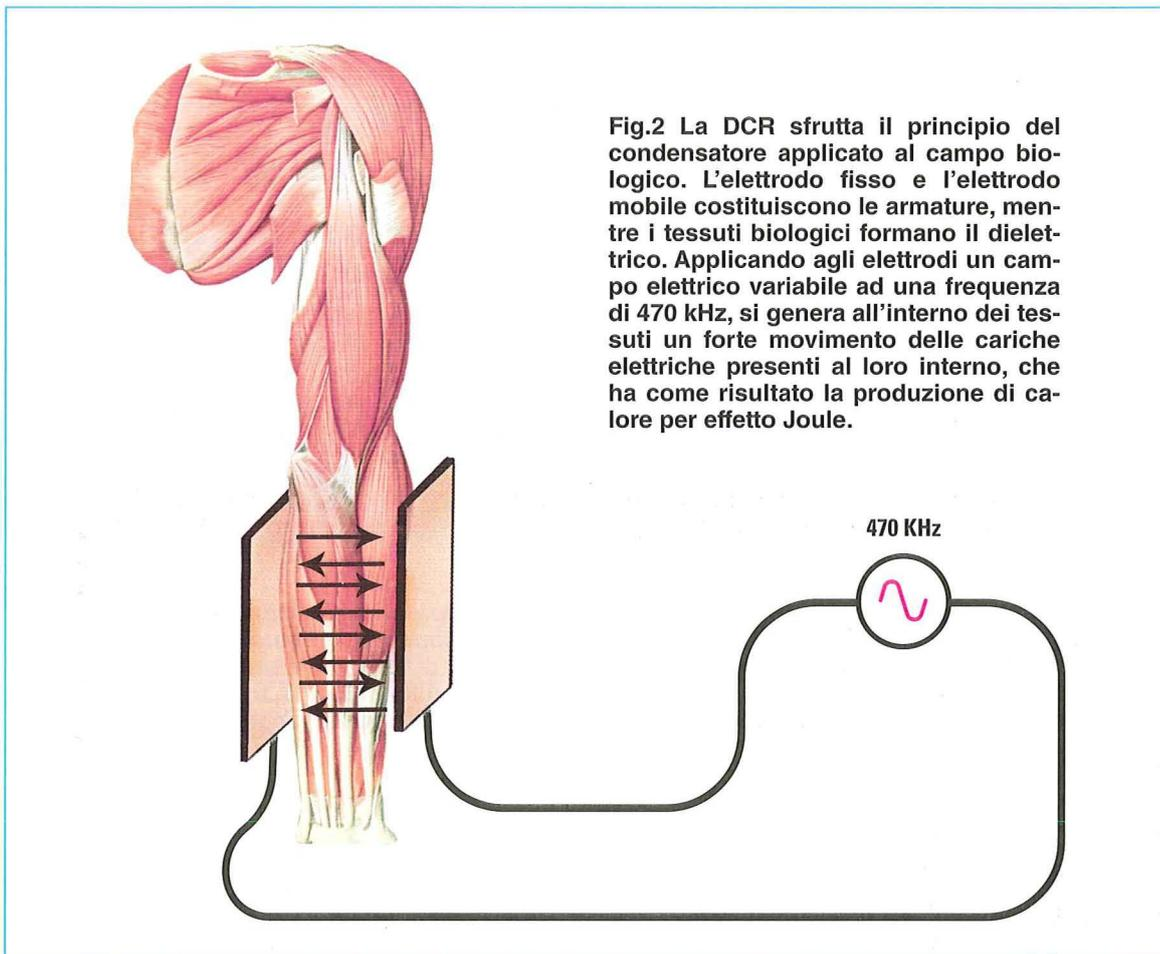
Fig.2 La DCR sfrutta il principio del condensatore applicato al campo biologico. L'elettrodo fisso e l'elettrodo mobile costituiscono le armature, mentre i tessuti biologici formano il dielettrico. Applicando agli elettrodi un campo elettrico variabile ad una frequenza di 470 kHz, si genera all'interno dei tessuti un forte movimento delle cariche elettriche presenti al loro interno, che ha come risultato la produzione di calore per effetto Joule.
