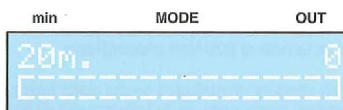
E' importante precisare che fin quando non si dà inizio al trattamento, inserendo l'elettrodo **mobile** e premendo successivamente il tasto **Start**, agli elettrodi **non** viene applicata **alcuna potenza**. Pertanto, qualunque sia la posizione della manopola di regolazione della potenza, all'accensione dello strumento, in uscita è presente una potenza **nulla**.
