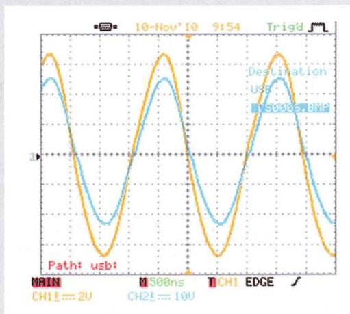
Nella misura con elettrodo **RESISTIVO** abbiamo ottenuto un valore medio di impedenza di circa **37-38 ohm**. Questo valore rappresenta unicamente l'impedenza propria del **tessuto biologico** interposto tra i due elettrodi, perché la resistenza di contatto tra gli elettrodi e la cute risulta trascurabile. Come potete notare la tensione e la corrente risultano **in fase** tra loro, indicando che l'impedenza dei tessuti ha un aspetto prevalentemente **resistivo**.
