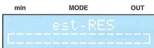
Lo strumento controlla anche che l'elettrodo sia **presente e correttamente inserito**. Nel caso in cui non sia stato inserito **alcun elettrodo** oppure il connettore non sia stato inserito **a fondo**, compare il messaggio
