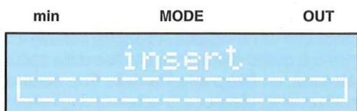
Se non viene inserito alcun elettrodo mobile, lo strumento **non parte**.
